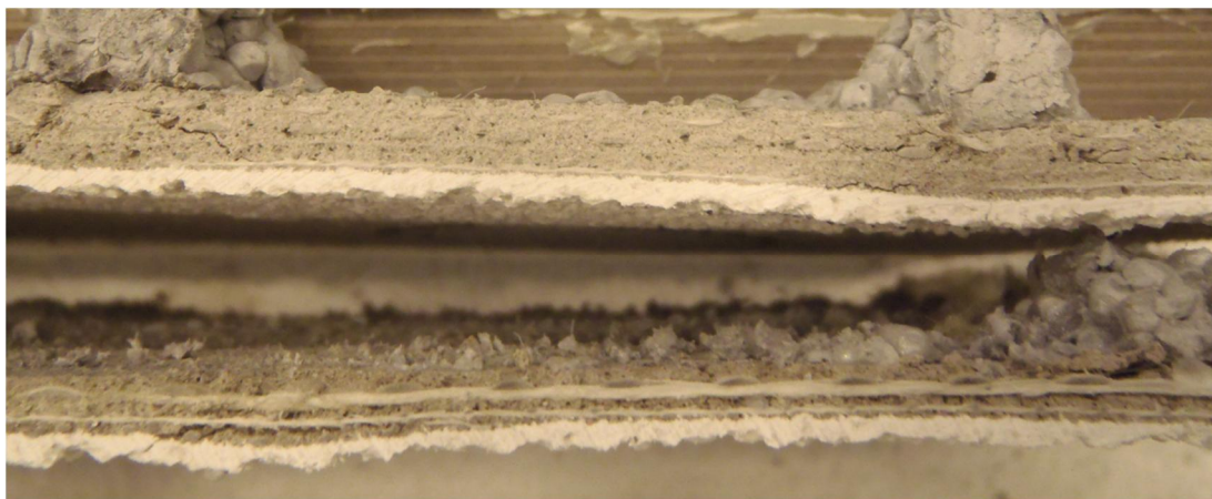
Kuva 4.4. Verkotuslaastikerroksen paksuuden vaihtelut iskulujuuskokeiden alueella vertailurakenteessa.
