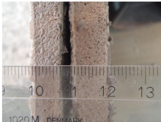
Kuva 5.2. Verkotuslaastikerroksen poikkileikkauksia panssariverkolla vahvistetulta alueelta.
